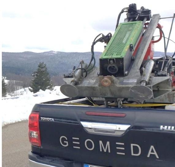
Il **PENETROMETRO DEEP DRILL** dinamico, compatto e facilmente trasportabile, consente di eseguire prove penetrometriche DPSH, DPM, SCPT, ecc. allo scopo di catalogare e parametrizzare il suolo attraversato con un'immagine in continuo; ciò permette di avere un raffronto sulle consistenze dei vari livelli attraversati e una correlazione diretta con sondaggi geognostici per la caratterizzazione stratigrafica.
